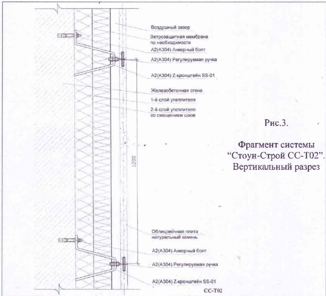
Рис.3. Фрагмент системы "Стоун-Строй СС-Т02". Вертикальный разрез
